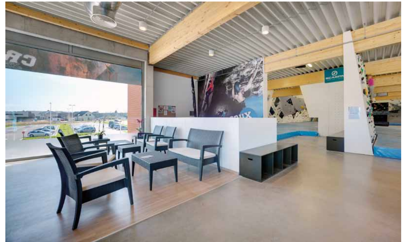
Geperforeerd metselwerk en houten constructies moeten de weerkaatsing en nagalmtijd beperken.
